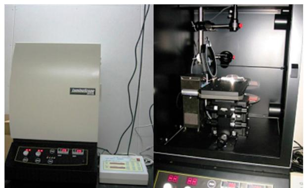
図4：CCDカメラ、インキュベーター体型の発光分子イメージング装置の外観(左)と内部(右)
