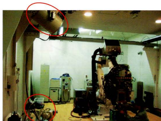
図 9 国際医療センター・戸山病院（新宿）に設置されたロボット型リニアックと次世代動体追跡装置。赤丸が次世代動体追跡装置部分。
