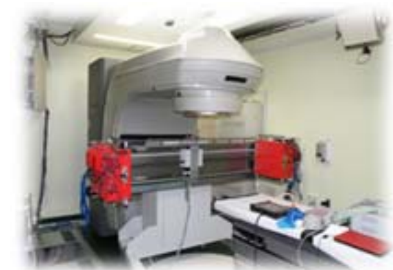
図14 アイソトープセンターに設置した対向型PET装置の装用放射線治療装置
